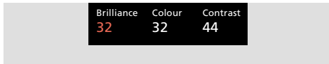
El menú Picture le permite ajustar Brilliance, Colour y Contrast. En algunos casos, estará disponible un cuarto ajuste llamado Tint.
